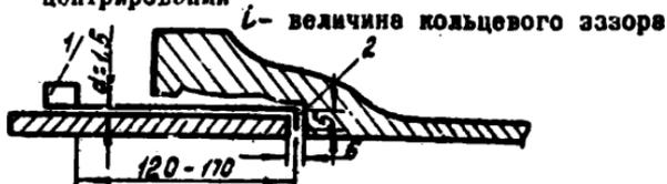
Рис. 5. Проволочный крючок для замера величины зазора
