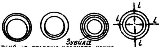
Рис.4. Центровка труб со стороны гладкого конца
