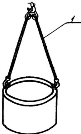
Рис.8. Строповка блоков колодца
