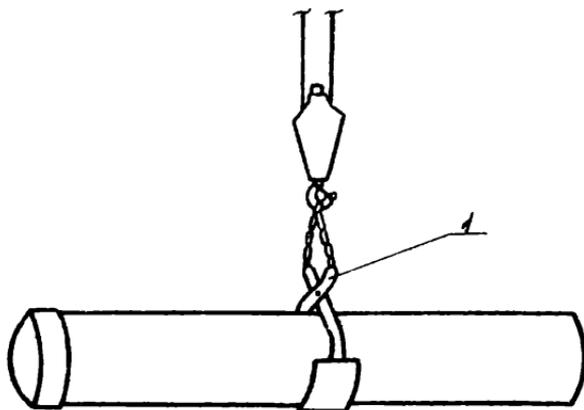
Рис.7. Строповка труб.
