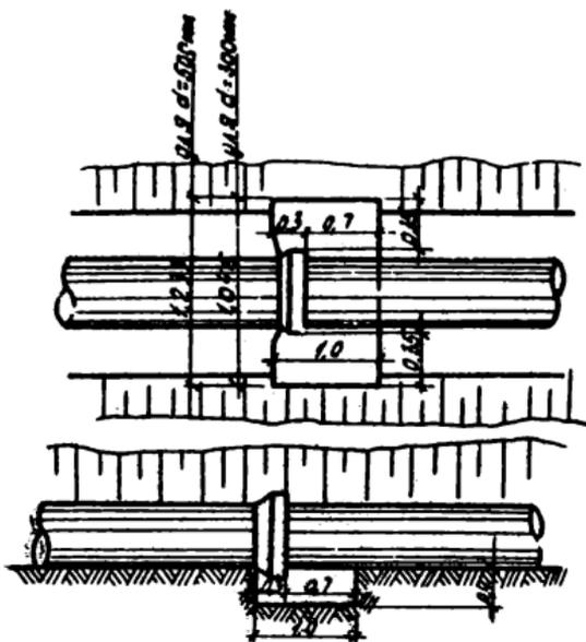
Рис.3. Прямо́к для заделки стыка.
