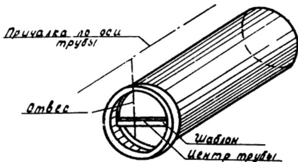
Рис.2. Центровка труб со стороны раструба.
