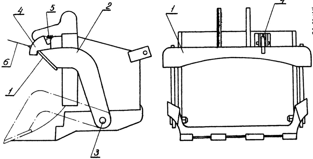
Рис. 4 Струв для зачистки дна траншеи экскаватором.
