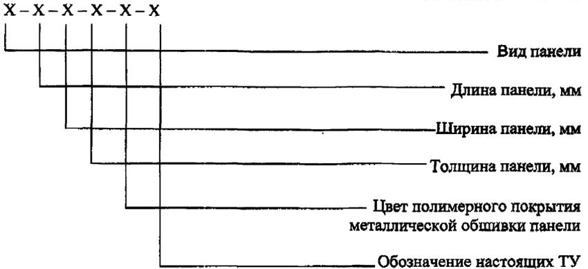
Пример условного обозначения панели кровельной металлической длиной 6м, шириной 1174мм, толщиной 180мм, цветом покрытия металлической обшивки – светло-серым RR 21.
