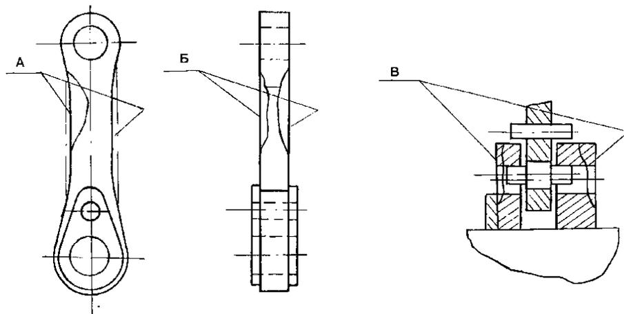
А– поверхность приварки уравнивающей массы фрезерования при подгонке массы билодержателя;
