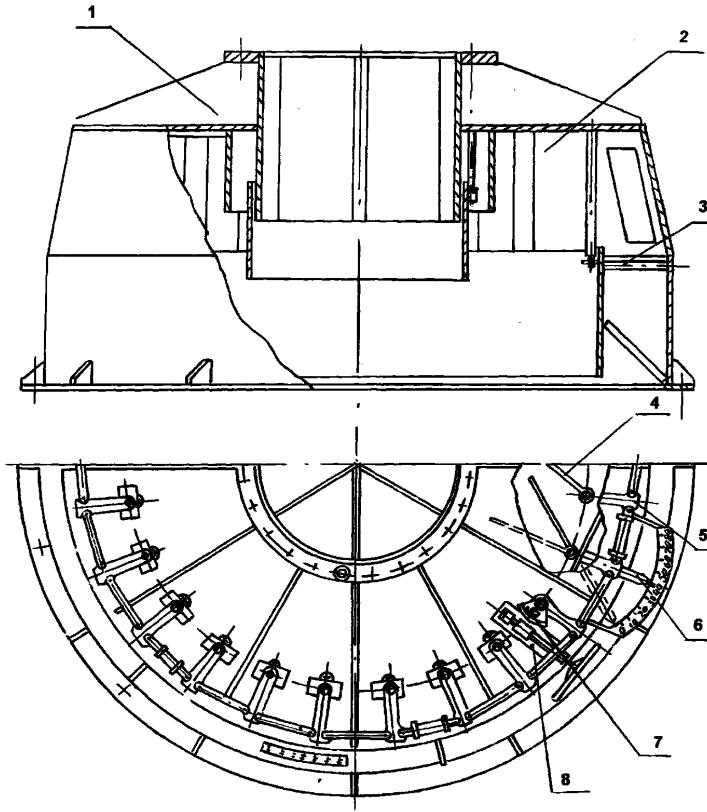
1– корпус сепаратора; 2– лопатка; 3– растяжка; 4– лопатка; 5– рычаг;
