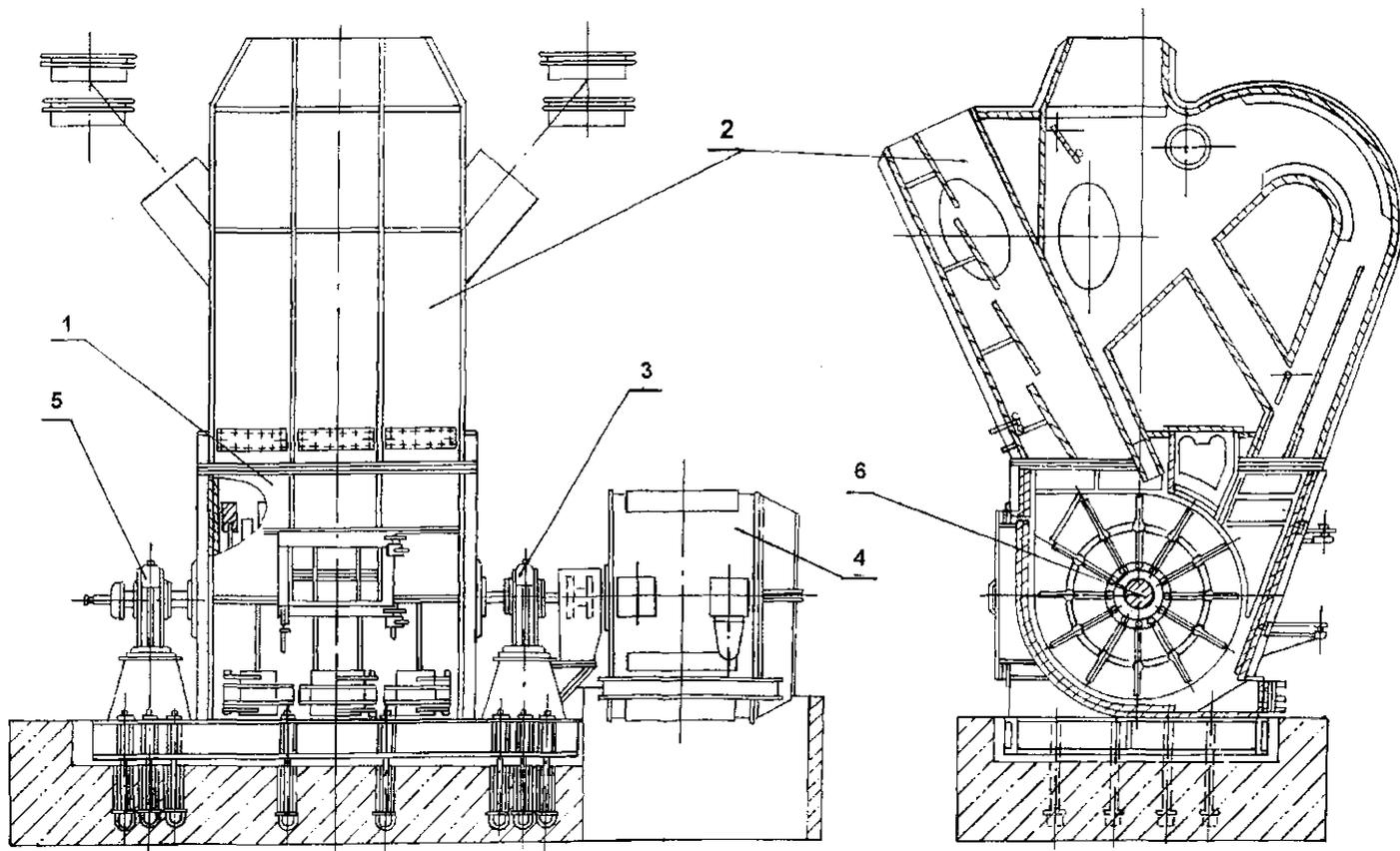
1— корпус мельницы; 2— сепаратор; 3— подшипник опорно-упорный;
