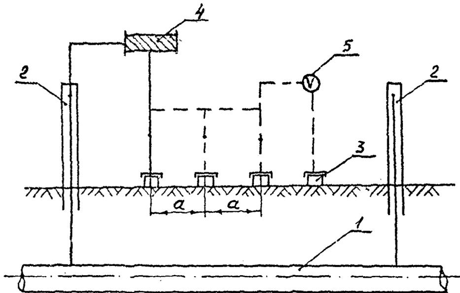
1 - трубопровод; 2 - КИП; 3 - МСЭ; 4 - катушка; 5 - вольтметр.
