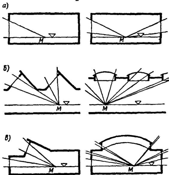
Рис. 1. Схема естественного освещения а — боковое освещение; б — верхнее освещение в — комбинированное освещение,  $\nabla$  — уровень рабочей плоскости
