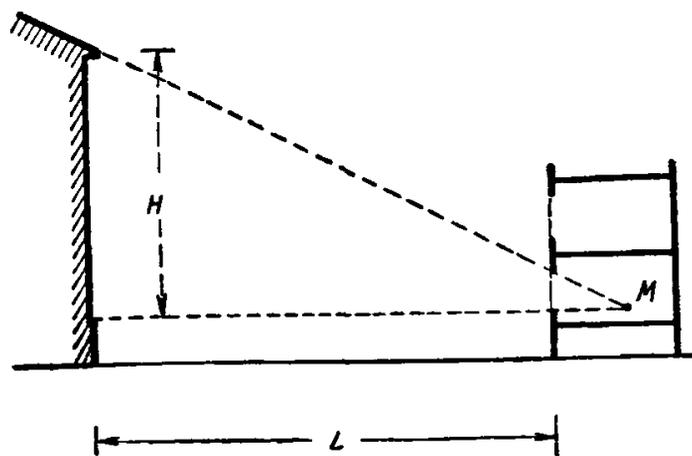
Рис. 5. Схема для определения коэффициент затенения
