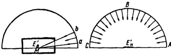
рис. 3. Схема для определения коэффициента небосвода  $e''_n$  — освещенность внутри помещения без учета светопотерь и отраженного света;  $E''_n$  — наружная горизонтальная освещенность при равномерной яркости неба
