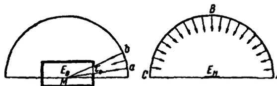
Рис. 2. Схема для определения коэффициента естественной освещенности
