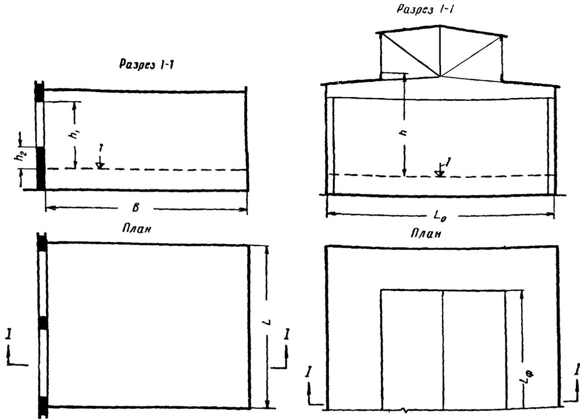
Рис. 4. Схема обозначения размеров здания и световых проемов для расчета естественного освещения
