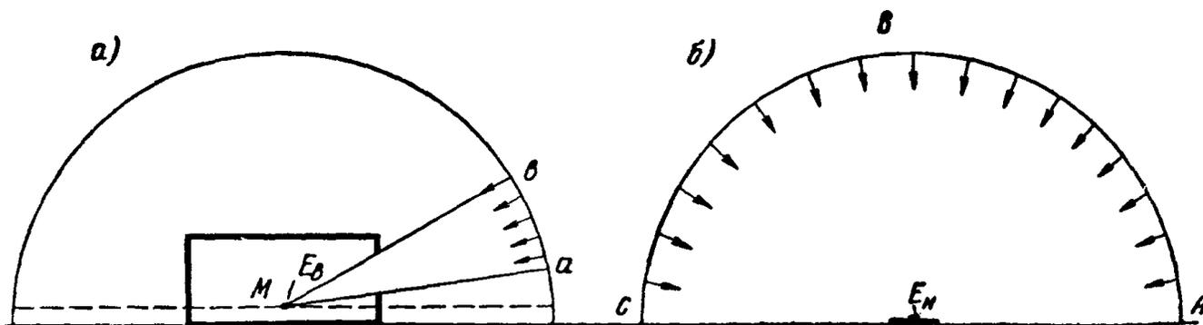
Рис. 1. Схема для определения коэффициента естественной освещенности
