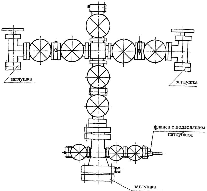
Рисунок Л.1 – Пример подготовки фонтанной арматуры к испытанию
