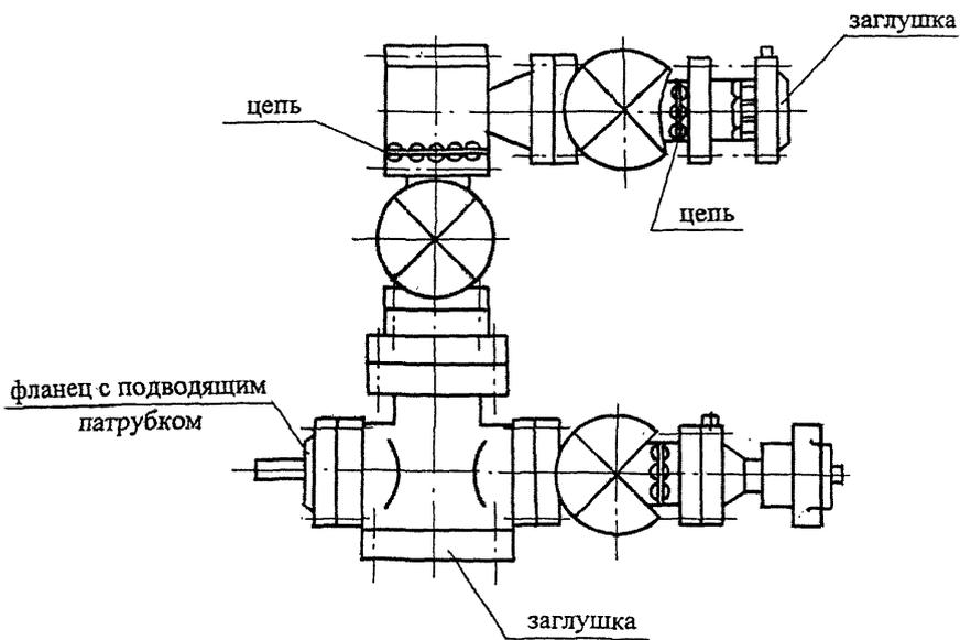
Рисунок Л.2 – Пример подготовки нагнетательной арматуры к испытанию
