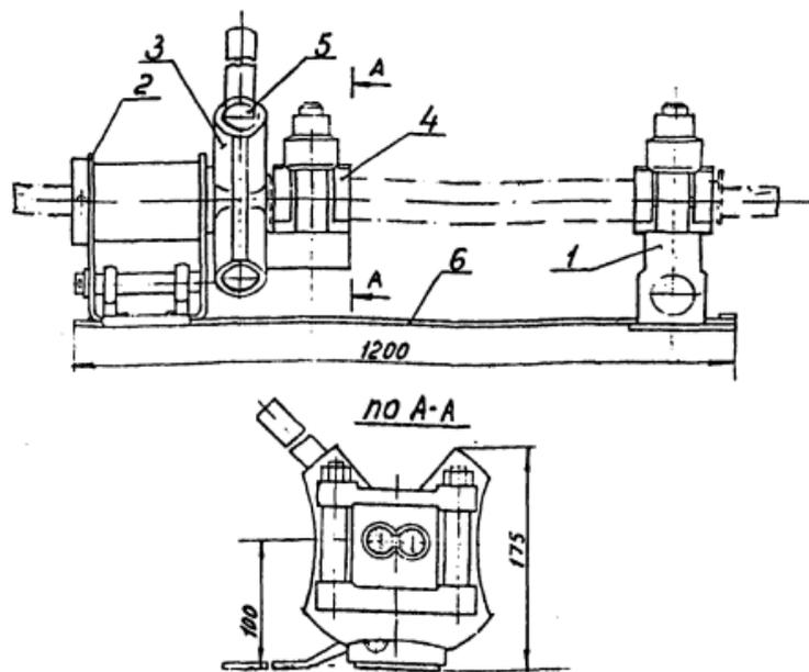
Приспособление МЦ-230А для скручивания
