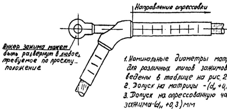
Рис. 2-4. Опрессовка линейной части корпуса зажима НАС.
