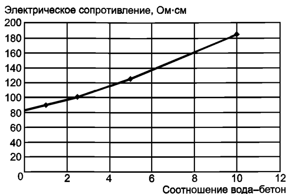
Рисунок 4 — Оценка электрического сопротивления водной вытяжки из бетона
