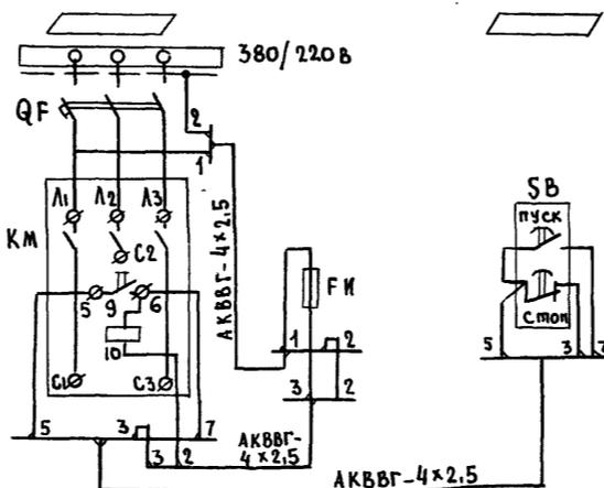
Схема управления наружным освещением.
