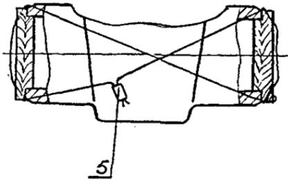
5. Закрытие патрубков деревянными заглушками. Пломба ставится на проволоке продетой через отверстие в заглушках
