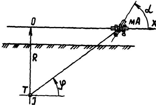
Рис. I. Взаимное расположение трубопровода Т с током  $J$  и магнитной антенны МА при определении трассы одноточечного трубопровода:
