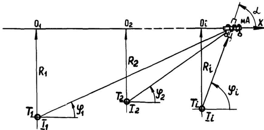
Рис.3. Взаимное расположение системы параллельных трубопроводов и магнитной антенны
