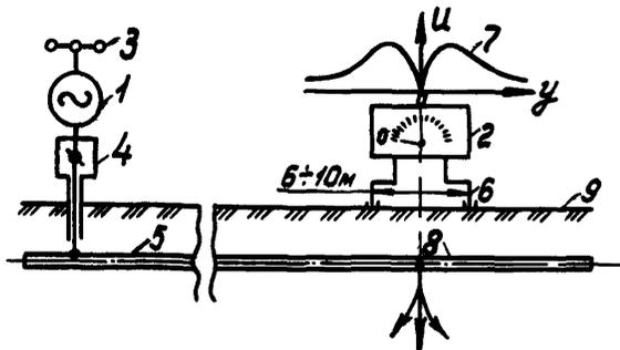
Рис. I. Схема поиска дефектов в изоляционном покрытии зашпанных одиночного трубопровода контактным продольным способом:
