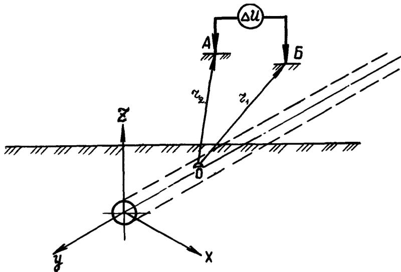
Рис.4. Схема определения дефекта в изоляционном покрытии:
