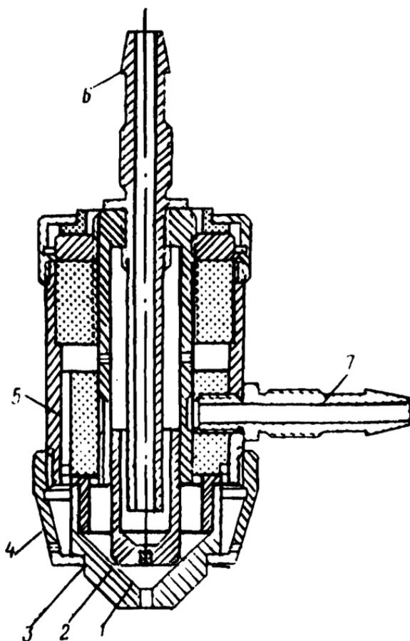
Рис.1. Плазмоторн с воздушным охлаждением:
