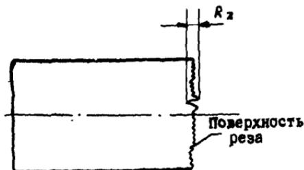
Рис.7. Шероховатость поверхности реза
