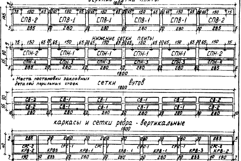
Схемы расположения сеток верхние сетки плиты
