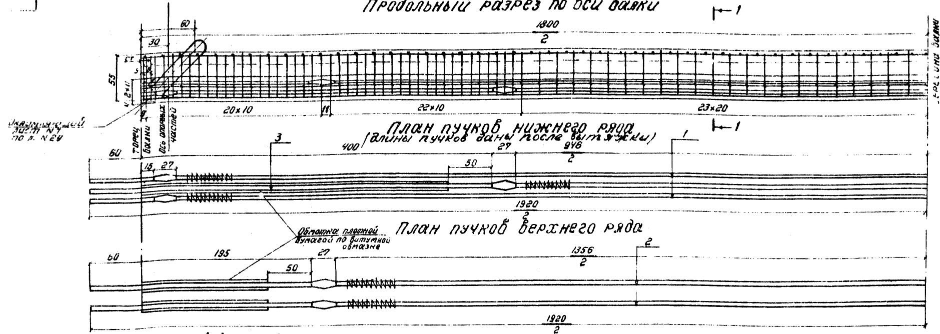
Схемы расположения сеток + места постановки закладных деталей перильных стоек
