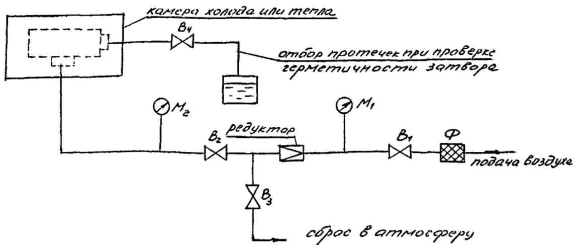
$M_1, M_2$  - манометры;  $B_1, B_2, B_3, B_4$  - клапаны;
