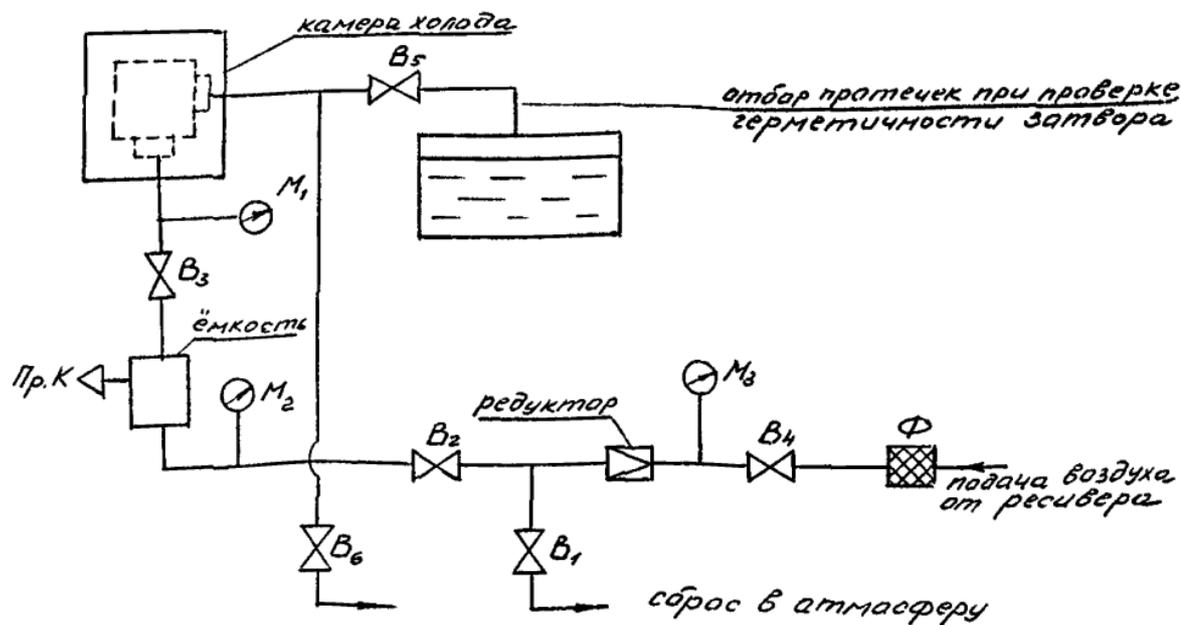
$M_1, M_2, M_3$  - манометры;  $V_1, V_2, V_3, V_4, V_5, V_6$  - клапаны;  $\Phi$  - фильтр; Пр.К - предохранительный клапан.
