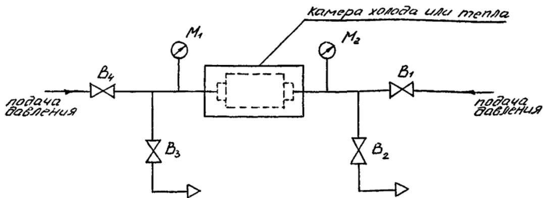
$M_1, M_2$  - манометры;  $V_1, V_2, V_3, V_4$  - клапаны.
