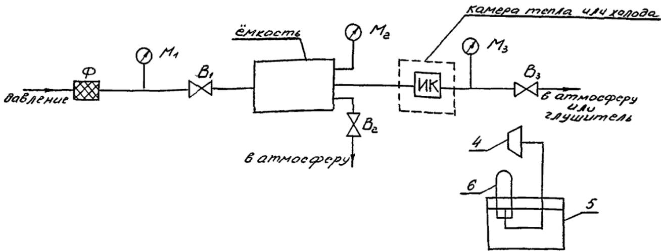
ИК - испытуемый клапан,  $M_1, M_2, M_3$  - манометры,  $B_1, B_2$  - клапаны запорные,  $B_3$  - задвижка или клапан запорный, 4 - пробка с отводной трубкой, 5 - емкость с жидкостью (для проверки протечек в затворе клапана), 6 - пробирка для замера протечек; Ф - фильтр.
