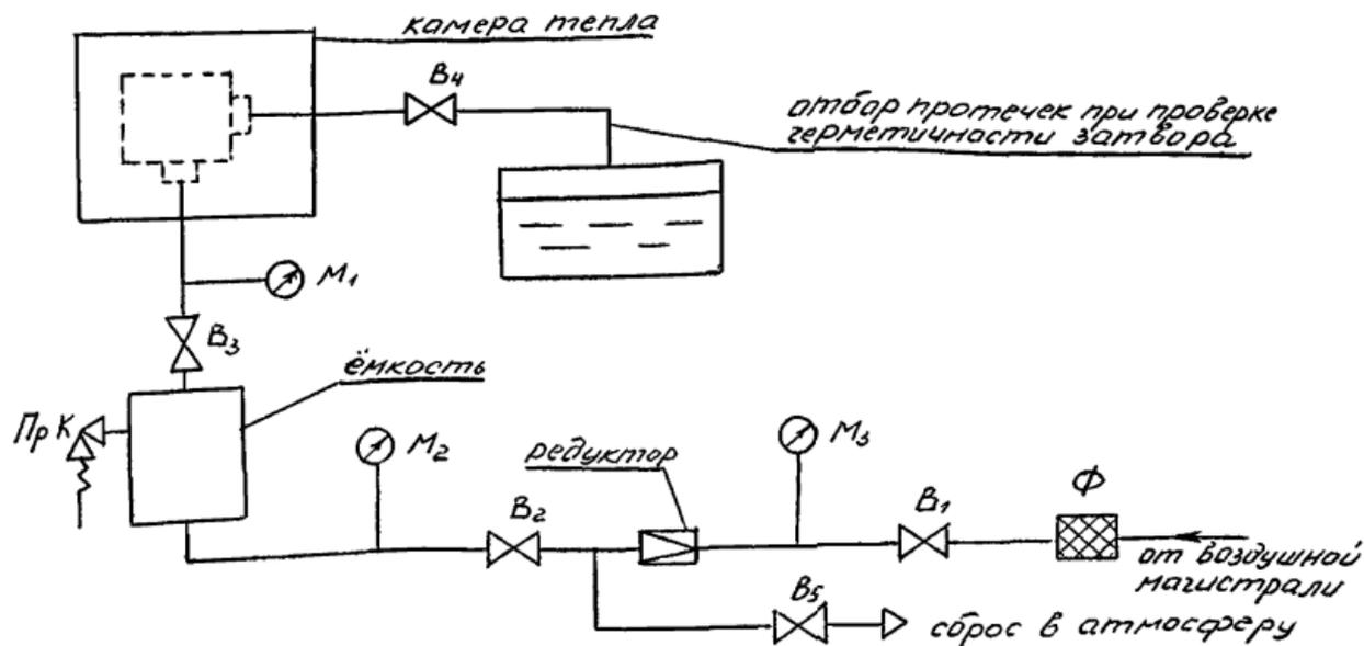
$M_1, M_2, M_3$  - манометры;  $V_1, V_2, V_3, V_4, V_5$  - клапаны;
