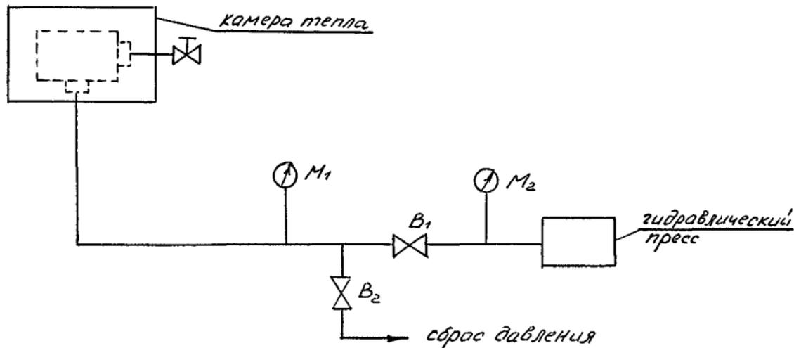
$M_1, M_2$  - манометры ;  $V_1, V_2, V_3$  - клапаны
