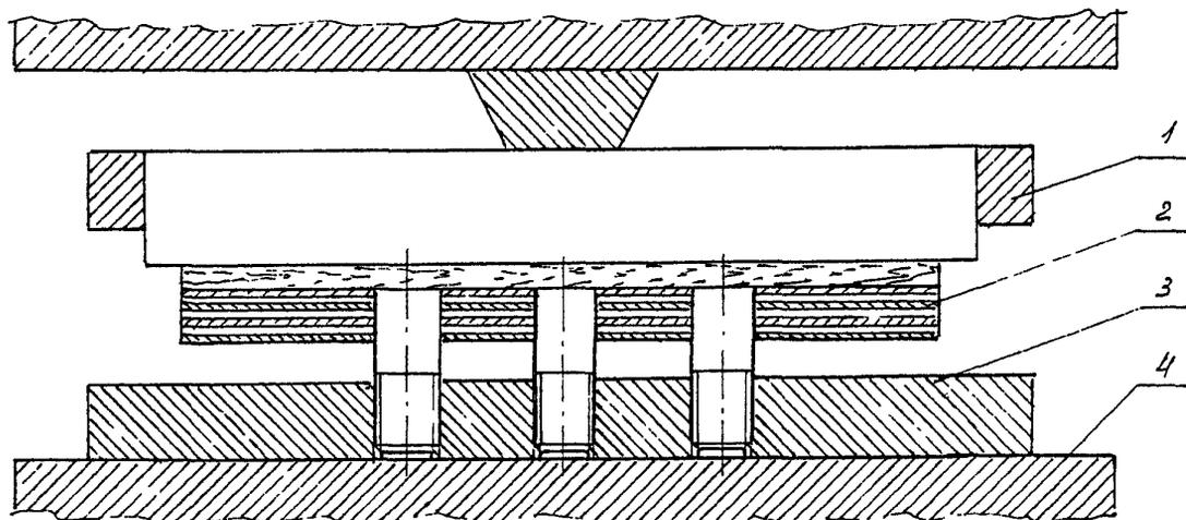
1-опорная планка; 2-образец для испытаний; 3-вилка;
