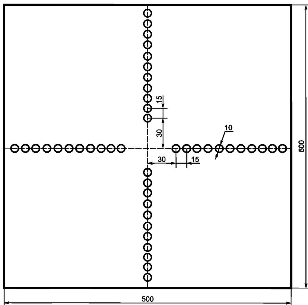
$d$  — диаметр отверстия (10 мм). Толщина тест-объекта 1 мм. Одна сторона полированная, другая подлежит чернению.
