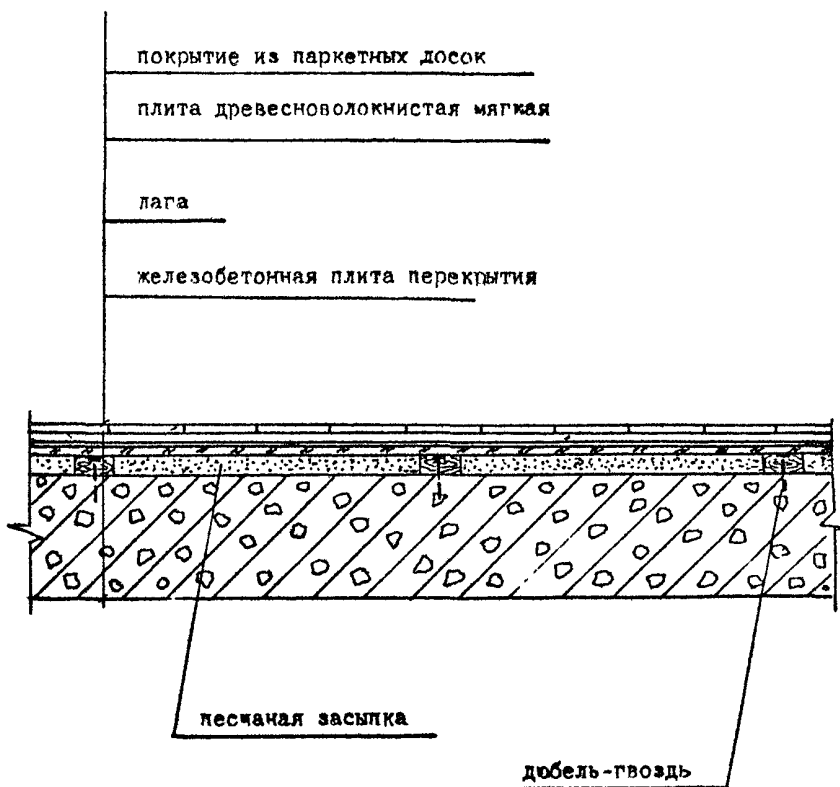
Рис.3. Конструкция пола из паркетных досок ПД-3 на лагах
