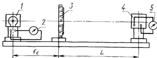
1—источник света; 2—вольтметр; 3—линза; 4—фотоэлемент; 5—гальванометр
