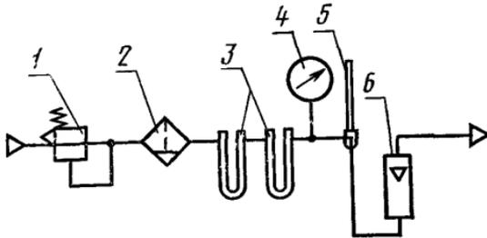
1—регулятор давления; 2—фильтр окончательной очистки; 3—трубки типа ТХ-V-2; 4—манометр образцовый; 5—термометр; 6—ротаметр типа РМ
