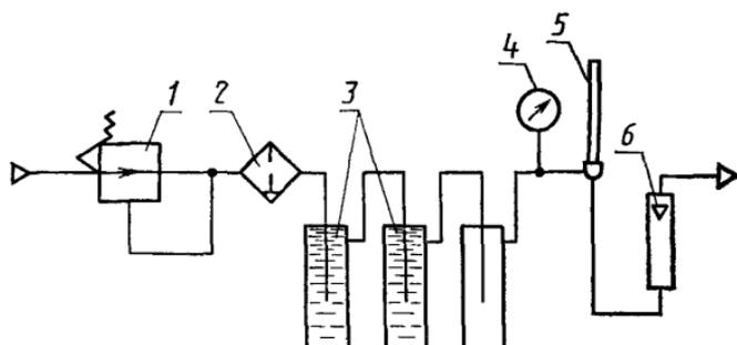
1—регулятор давления; 2—фильтр окончательной очистки; 3—погло-
