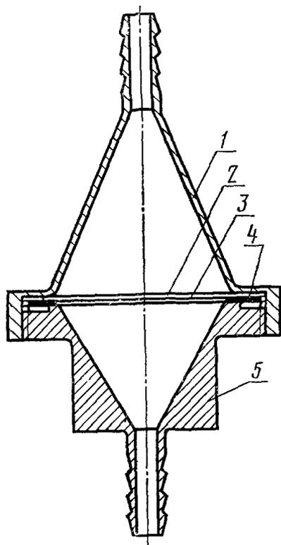
1—корпус фильтродержателя, 2—сетка по ГОСТ 3826—82 (от № 04 до № 2); 3—фильтр АФА-ВП-20; 4—прижимное кольцо; 5—крышка фильтродержателя
