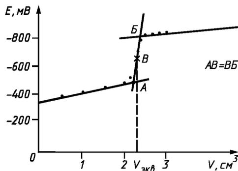
Рисунок 1 — Определение эквивалентного объема при титровании анализируемого раствора
