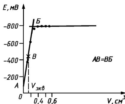
Рисунок 2 — Определение эквивалентного объема при контрольном титровании растворителя
