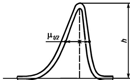
Рисунок 4 — Пример измерения высоты и ширины пика
