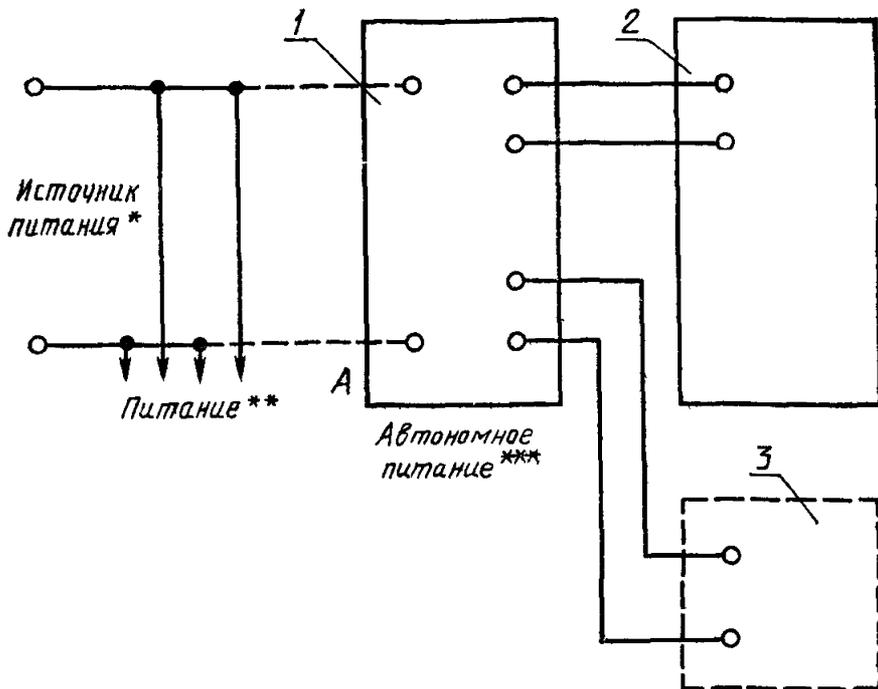
1 — вспомогательный источник реле (входной интерфейс); 2 — статическое измерительное реле; 3 — статические измерительные реле (см. примечание 3)
