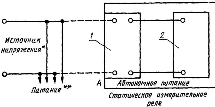
1 — вспомогательный источник реле (входной интерфейс); 2 — статические цепи
