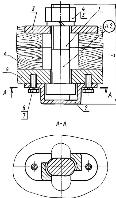
1 — болт см табл 1, 2 — корпус 0298-0361/002 (кол 1), 3 — заглушка 0298-0361/003 (кол 1), 4 — гайка М20 6 05 по ГОСТ 5927 (кол 1), 5 — шайба 20 65Г 05 по ГОСТ 6402 (кол 1), 6 — болт М6-6гх16 56 05 по ГОСТ 7805 (кол 1), 7 — шайба 6 65Г 05 по ГОСТ 6402 (кол 1), 8 — модель, 9 — модельная плита
