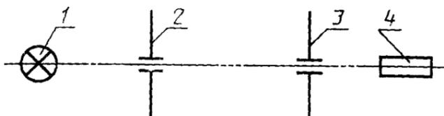
1.4.1. Лампа 1, параметры которой измеряют, должна находиться на оптической оси установки.
