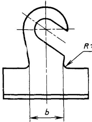
Стандарт дополнить пунктом — 4а: «4а. Допускаются выступы от перемычек в цепи кабельных наконечников высотой не более 0,3 мм».
