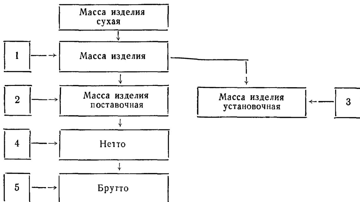
1—масса смазочных материалов и нестив емых жидкостей; 2—масса вспомогательных устройств и веществ включая массу частей изделий, указанных в сопроводительной документации, 3—масса устройств индивидуальной амортизации и креплений с межблочной и межэлементной связью, а также с другими устройствами и веществами, необходимыми при эксплуатации данного изделия, 4—масса сопроводительной документации, 5—масса тары
