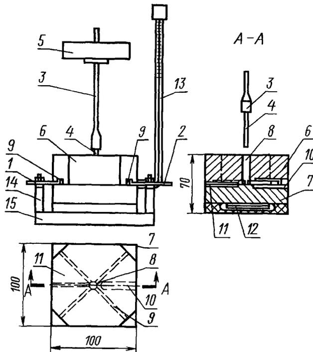
1 и 2 — образцы провода; 3 — стержень; 4 — керамический наконечник; 5 — груз; 6 — верхняя плита; 7 — нижняя плита; 8 — отверстие для стержня; 9 — прорезы для образцов провода; 10 — отверстие для термометра; 11 — отверстие для термопары; 12 — нагревательный элемент; 13 — терморегулятор; 14 — клеммы для закрепления образцов и подключения к ним напряжения; 15 — изолированная подставка
