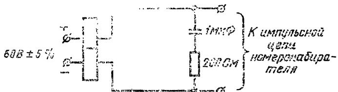
*R*—телефонное реле типа РПН с симметричными обмотками и пластиной отлипания 0,5 мм. Каждая из обмоток должна иметь сопротивление 490 Ом и 6100 витков из провода 0,112 ПЭЛ ГОСТ 2773—78 или ПЭТВ-1 и индуктивность не менее 2 Гн.
