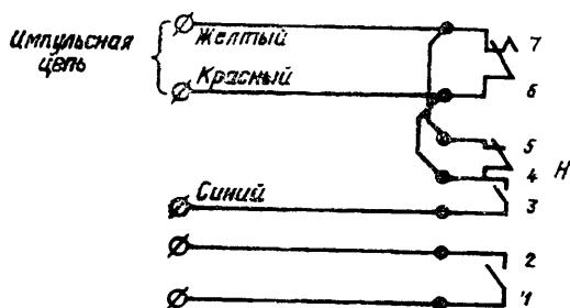
H1,2—шунтирующие контакты (замыкающие на коротко телефон при наборе номера); H3,4—шунтирующие контакты (замыкающие накоротко разговорную цепь при наборе номера); H4,5—шунтирующие контакты (замыкающие накоротко импульсные контакты H6,7); H6,7—импульсные контакты.
