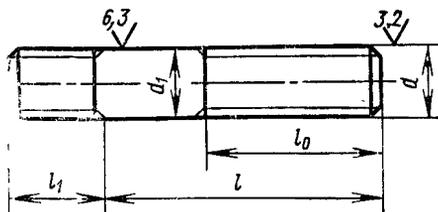
Примечание. Допускается изготовление шпилек с диаметром стержня приблизительно равным среднему диаметру резьбы. В обозначении этих шпилек после слова «Шпилька» следует указывать цифру 2.
